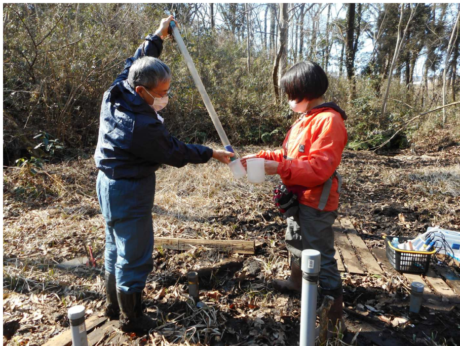
2.畔田谷津定期調査(地下水の採取状況)
