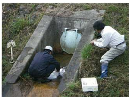
流量調査の基本? 土嚢とストップウォッチで流量測定
