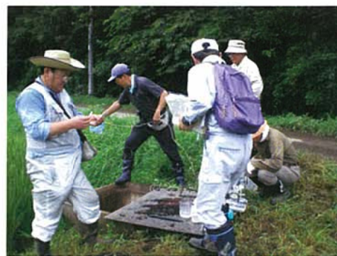
水田に通された暗渠排水の口を開け、採水や 2 価鉄などの現地測定を行いました。
